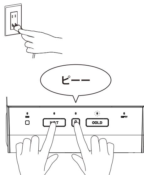
※ 給水中に給水タンク内の水が少なくなると、EMPTY ランプが点灯し、ピーーと音がして給水が停止します。EMPTY ランプが消えるまで水を注ぎ足し、②～③の確認作業をおこなってください。
