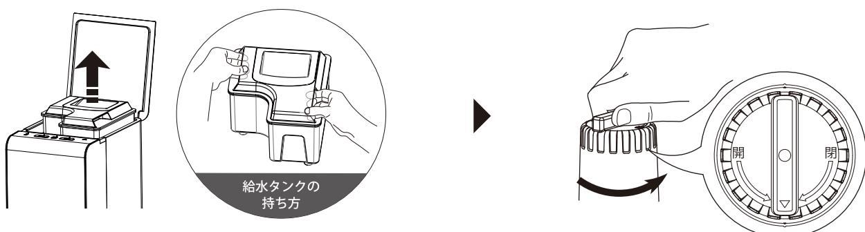
② カバー内部を乾いた布等で拭き取り、給水口と浄水カートリッジ挿入口を細いブラシ等で清掃してください。
