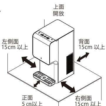
※1 水受け皿の落下防止のため水受け皿が卓上内に収まるように設置してください。
